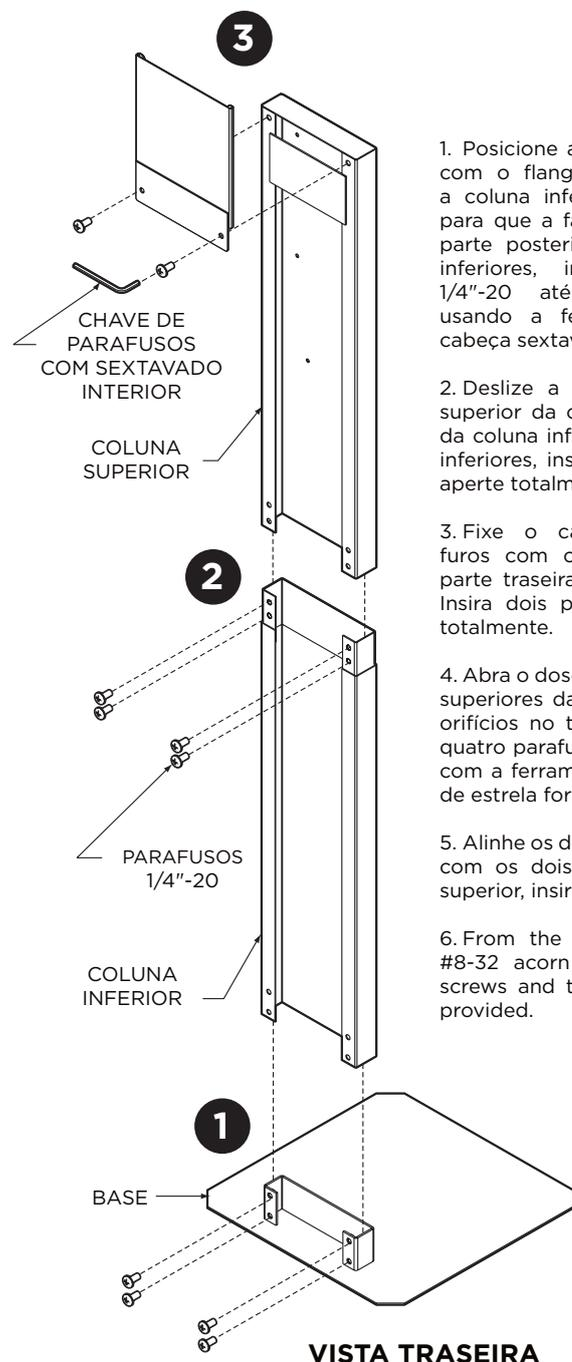
1. Posicione a base na localização desejada com o flange voltado para cima. Deslize a coluna inferior sobre o flange da base para que a face aberta da coluna fique na parte posterior. Alinhe os quatro orifícios inferiores, insira quatro parafusos de 1/4"-20 até apertá-los completamente usando a ferramenta de montagem de cabeça sextavada incluída.
